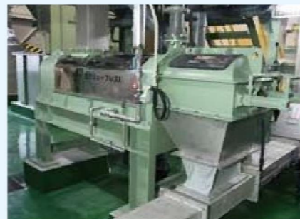
2F/スクリュープレス ドラムスクリーンで分離した夾雑物を脱水します。
